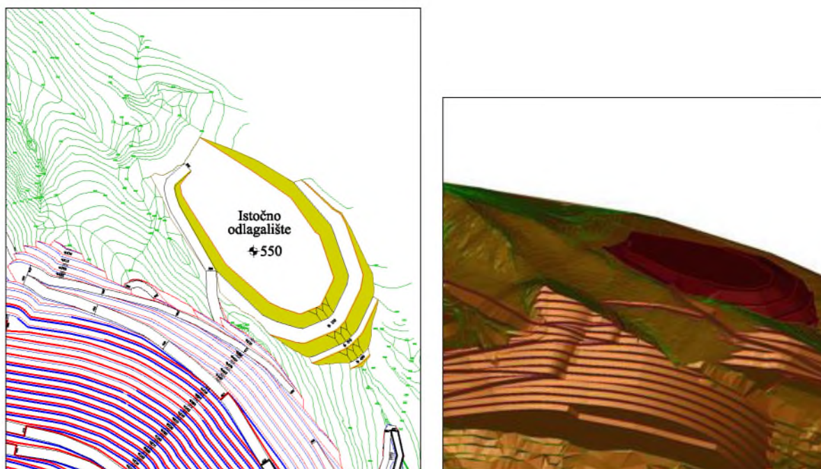
Slika 7.5. . Izgled konačne projektovane konture odlagališta Istočno odlagalište, 2D i 3D prikaz
