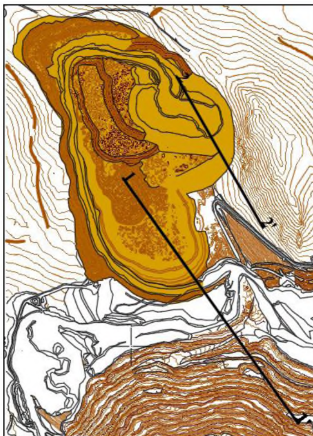
Slika 9.5. Položaj profila za analizu stabilnosti odlagališta „Todorov potok“
